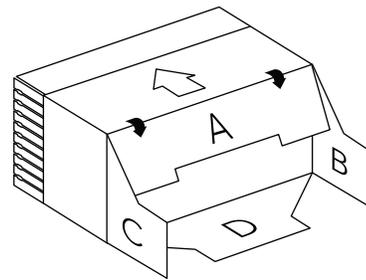
3 Pliez les rabats B et C vers l'intérieur en suite pliez le rabat D et insérez son languette dans la fente créée par les rabats A B et C
